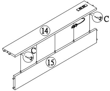
2 D. カムロック受けをセットした⑬宮棚用天板、ステップ1、⑯宮棚用ヘッドボードに⑪宮棚用左側板、⑫宮棚用右側板を図のようにD. カムロックボルトとC. ボンドで取り付けます。
