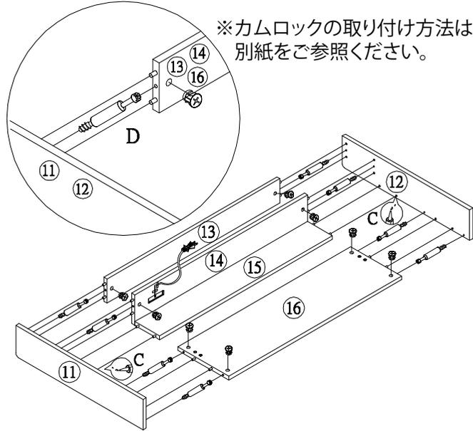
3 ①サイドフレームAと②サイドフレームBにF.L字取付け金具をH. ネジ④で図のように取り付けます。
