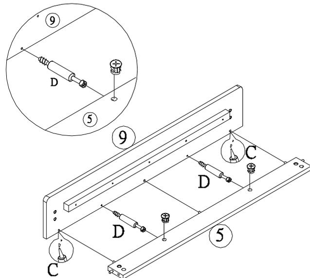
6 ステップ4の⑤フット用補強板に図のようにJ. 木製脚を回して取り付けます。
