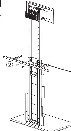
②ブラケットの取付場所を変更する事で、専用棚の高さを3段階で調整できます。
